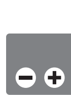
Рисунок 1 (Расположение полюсных выводов АКБ емкостью 110 А/ч и менее)
